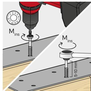
建议使用具有精制扭力的电钻, 例如 TORQUE LIMITER。或者, 使用扭矩扳手拧紧。
